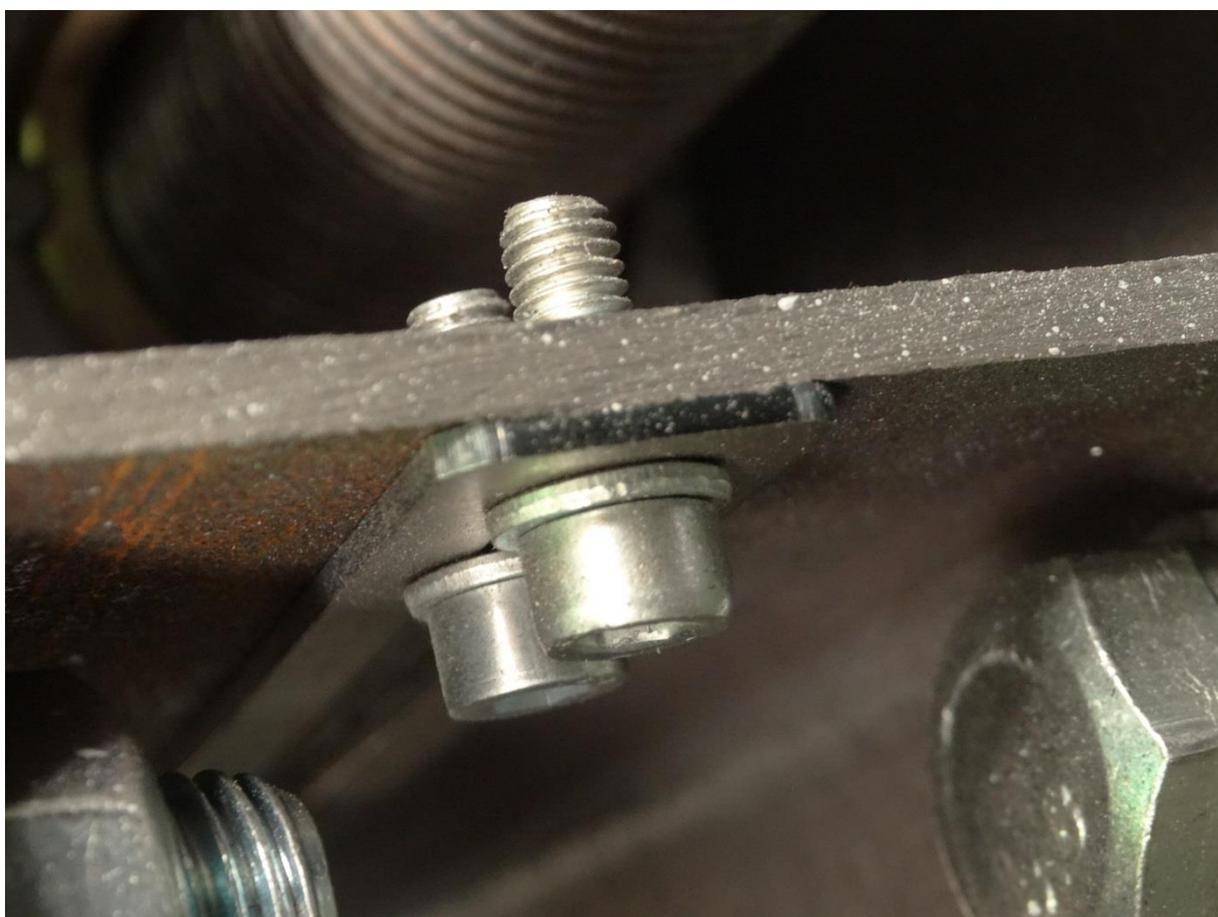
*Рисунок 4 – Передвижная пластина регулировки конечного выключателя.*
