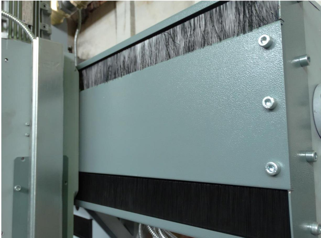
*Рисунок 5 – Пылезащитные щеточные уплотнители горизонтальной стойки*
